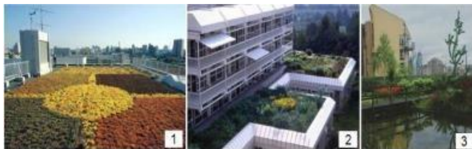
Figura 3 - Telhado verde extenso (1), semi-intensivo (2), intensivo (3).
